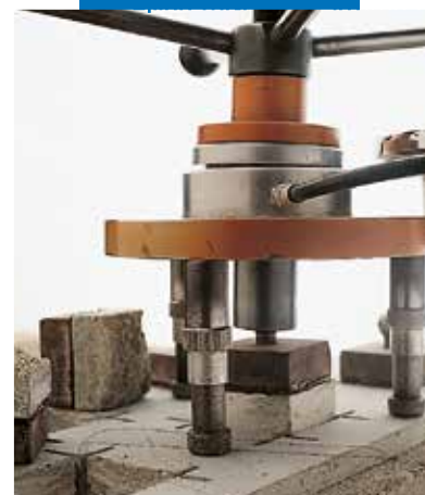
Испытание на адгезию SATTEC
